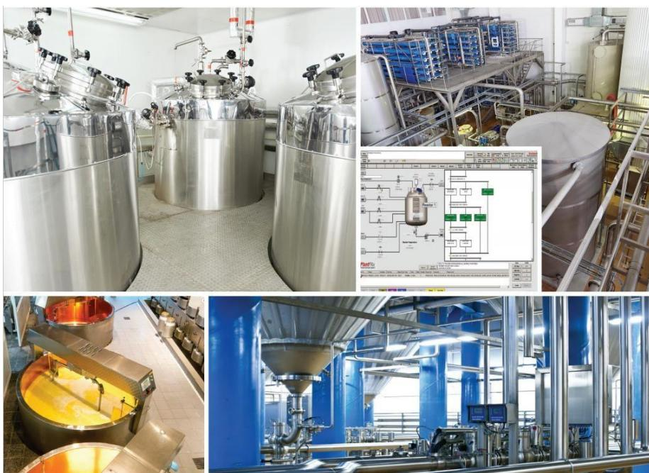
**FactoryTalk® Batch** sustav je za potpunu kontrolu automatiziranih, polu-automatiziranih i ručno izvedenih serijskih procesa. Dizajniran je u skladu sa ANSI ISA S88 standardom za projektiranje i konfiguraciju batch sustava. Tipične primjene su u kemijskoj, farmacijskoj i prehrambenoj industriji, industriji pića itd.
