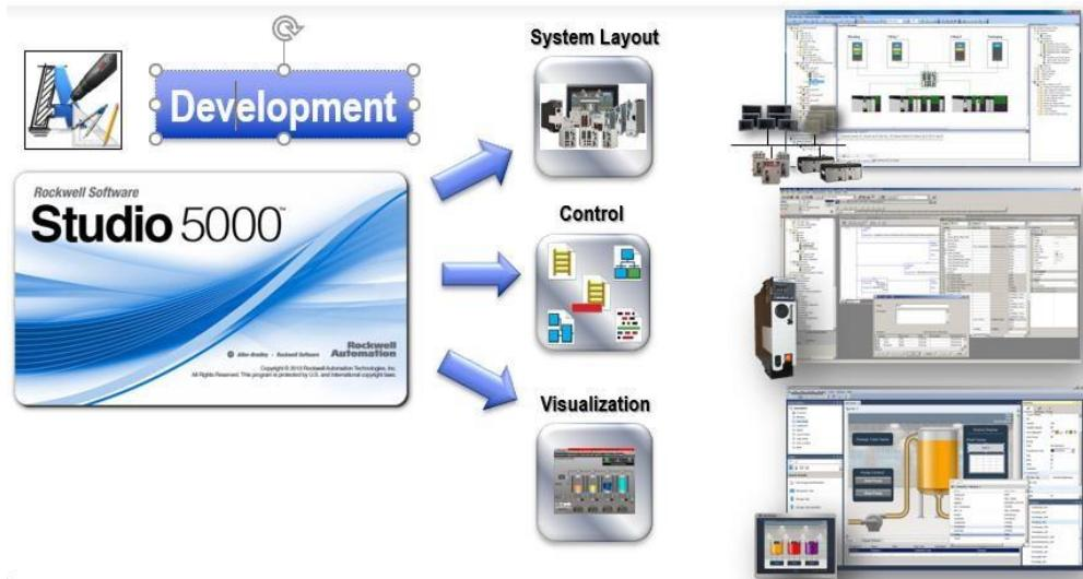
**Studio 5000®** je IDE (*Integrated Developer Environment*) dizajniran za razvoj aplikacija za industrijsku automatizaciju. **Studio 5000®** uključuje sljedeće razvojne module:
