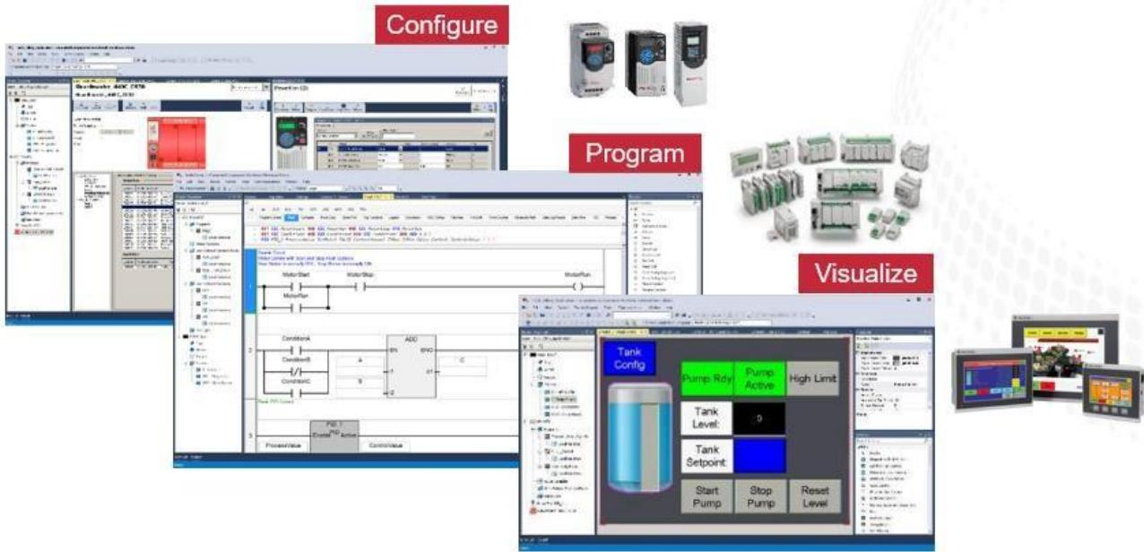
**Connected Components Workbench™** razvojno je okruženje koje se koristi za kreiranje softverskih aplikacija za upravljačke sustave serije **Micro800®** i aplikacija za vizualizaciju **HMI** (*Human Machine Interface*) za operacijske panele serije **PanelView800**.
