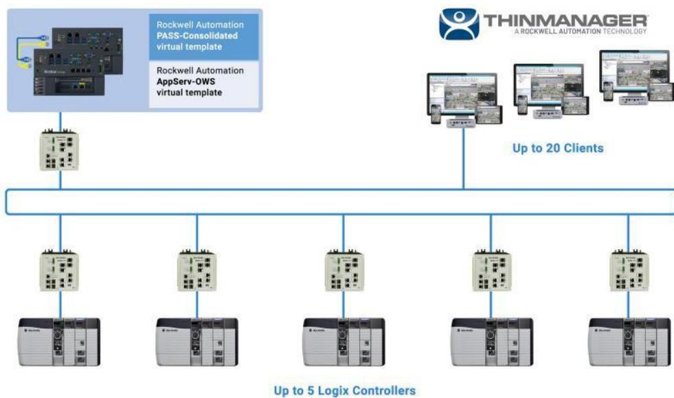
Stratus® ztC Edge pruža industrijsku platformu Edge Computing za Rockwell Automation® PlantPAx®. Platforma kombinira računalnu redundantnost kako bi se uklonili neplanirani zastoji, virtualizaciju za istovremeno pokretanje više softverskih zadataka i industrijski dizajn koji zadovoljava zahtjeve klase 1, divizije 2 za rad u opasnim okruženjima. Testirana arhitektura Solution-in-a-Box uključuje:
