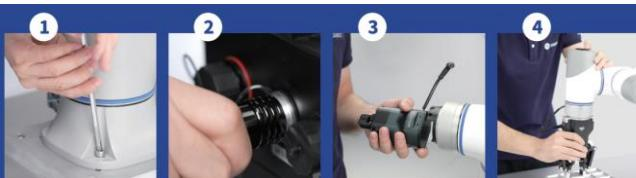
Roboti serije CR mogu se koristiti u različitim primjenama kao što su utovar i istovar, montaža, testiranje, rukovanje, uvrtanje, brušenje i više. Za ispravnu funkcionalnost u gore navedenim aplikacijama potrebno je koristiti različite krajne efektore. Najčešće takve hvataljke uključuju vakuumske čašice, pneumatske ili magnetske hvataljke ili glave za zavarivanje.
